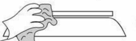
5. vyčkejte cca 5 minut po nanesení primeru - látka pro lepší přilnavost (pokud je součástí dodávky - v ostatních případech možno instalovat bez použití primeru)
