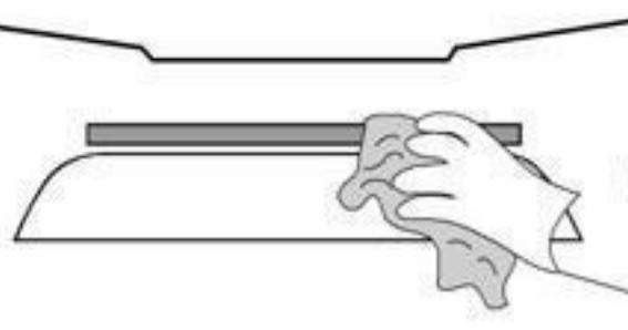
7. po přiložení důkladně přitlačte pomocí suchého hadru. tlak vyvíjte po dobu cca 1minuty. styčné plochy by měly mít min. 18°C
