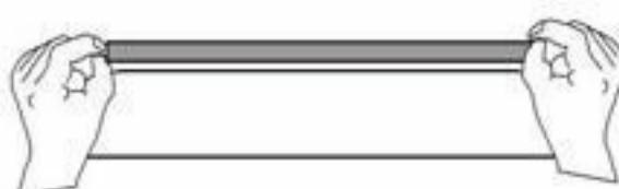
3. před samotnou montáží a odlepením ochranných folíí / samolepících pásek nejdříve výrobek přiložte na místo určení a vyzkoušejte, zda dobře pasuje
